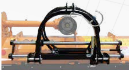
Desplazamiento hidráulico con tubos y acoples rápidos
