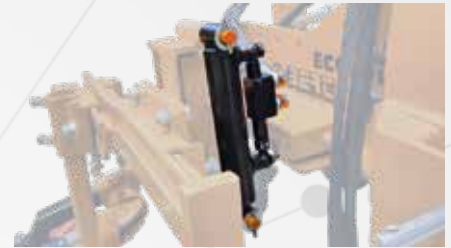
Höhenverstellung des Körpers mit hydr. Schläuchen und Schnellkupplungen
