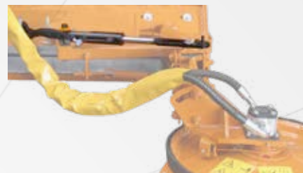
Einzugszylinder für Scheibe mit Schlauchen und Schnellkupplungen
