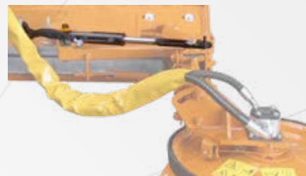
Einzugszylinder für Scheibe mit Schläuchen und Schnellkupplungen
