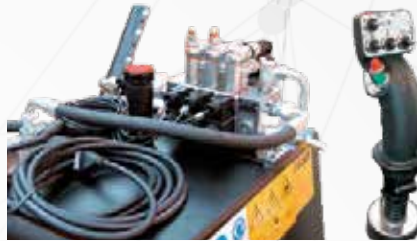
Elektrische Steuerung mit Joystick und Elektroventilen
