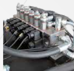
Elektrische Steuerung für 10 Funktionen mit Gegenneigunseinstellung
