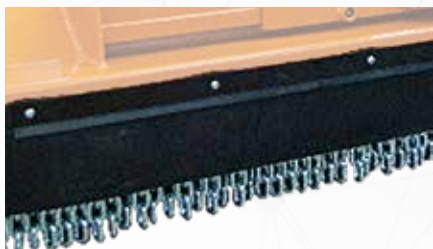
Protection frontales en chaînes et caoutchouc
