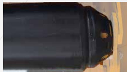
Rouleau palpeur de Ø 194 avec coupelles boulonnées
