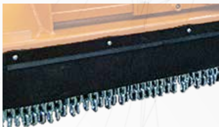
Protection frontales en chaînes et caoutchouc
