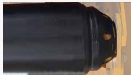
Rouleau palpeur de Ø 159-194 avec coupelles boulonnées
