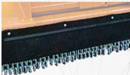
Protection frontales en chaînes et caoutchouc
