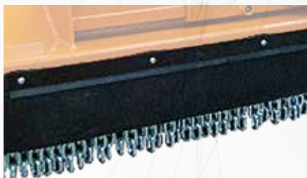
Protection frontales en chaînes et caoutchouc
