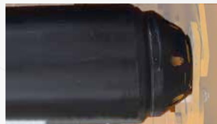
Rouleau palpeur de 159 mm avec coupelles boulonnées
