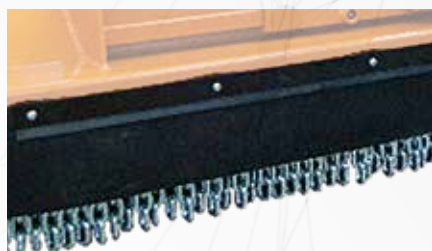
Protection frontales en chaînes et caoutchouc
