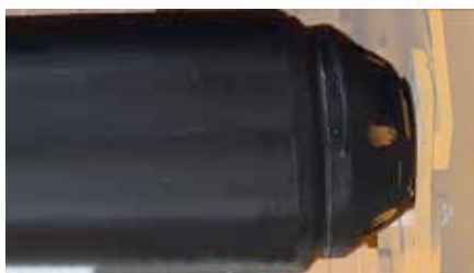
Rouleau palpeur de Ø 159-194 avec coupelles boulonnées
