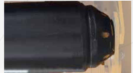
Stützwalze Ø 194 mit geschraubten Lagerungen
