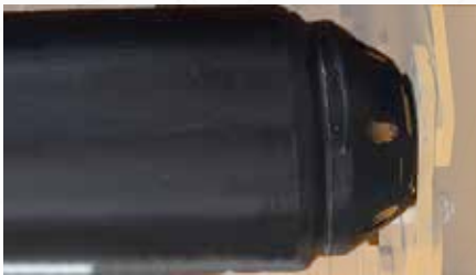
Stützwalze Ø 159 mit geschraubten Lagerungen
