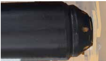
Stützwalze ø 159 mit geschraubten Lagerungen
