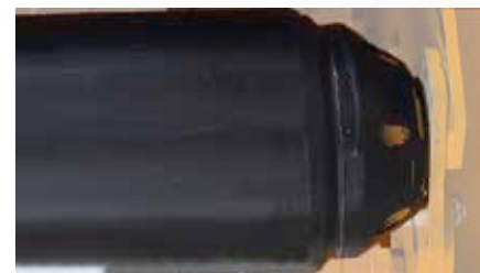
Rullo posteriore a campane imbullonate da 159 mm con pulirullo
