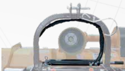
Desplazamiento hidráulico con tubos y acoples rápidos
