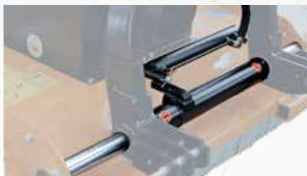
Desplazamiento hidráulico con tubos y acoples rápidos
