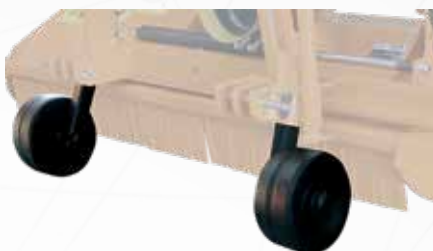
Ruedas estabilizadoras delanteras regulables en altura
