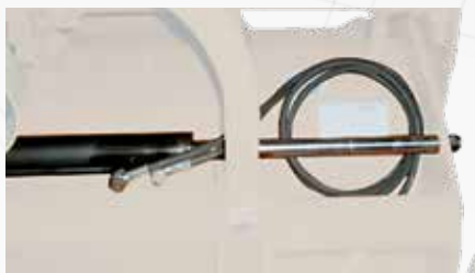
Desplazamiento hidráulico con tubos y acoples rápidos
