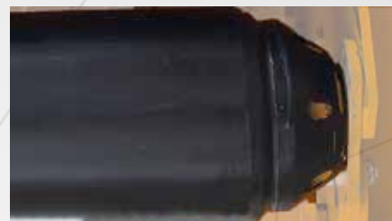
Rodillo nivelador de Ø 159 con tapas atornilladas y dobles cojinetes
