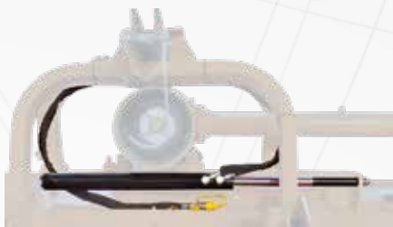
Desplazamiento hidráulico con tubos y acoples rápidos
