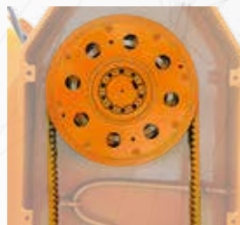
Innesto Centrifugo consigliato con rotore forestale
