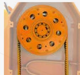
Innesto Centrifugo consigliato con rotore forestale
