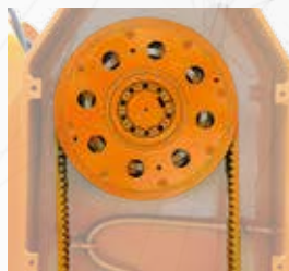
Innesto Centrifugo consigliato con rotore forestale
