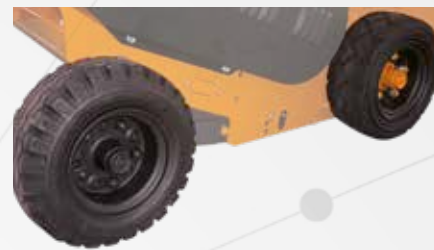
Ruote posteriori in gomma fisse in sostituzione del rullo posteriore
