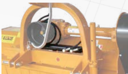
Spostamento idraulico con tubi e innesti rapidi
