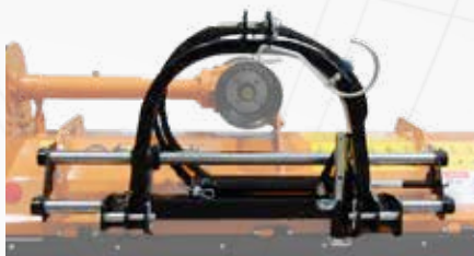
Spostamento idraulico con tubi e innesti rapidi
