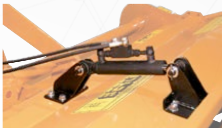
Apertura/chiusura idraulica del cofano con tubi e innesti rapidi
