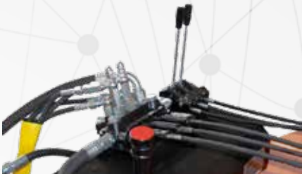
Juego de cables de control para ajustar la inclinación y la altura
