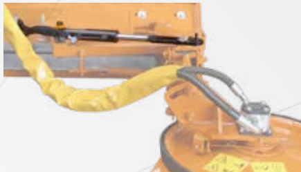
Cilindro hidráulico para by-pass manual del giro del disco
