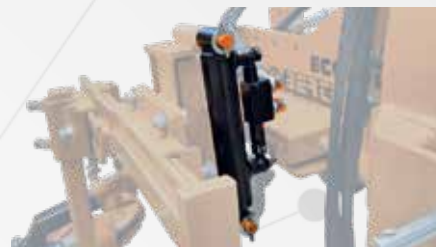
Levée hydraulique avec tuyaux et prises rapides
