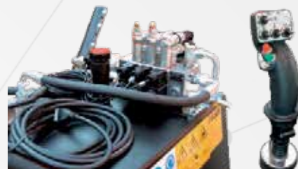
Commande électrique par joystick avec électrovannes
