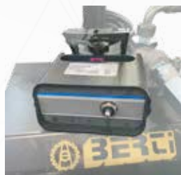
Engagement/arrêt moteur avec dispositif électrique
