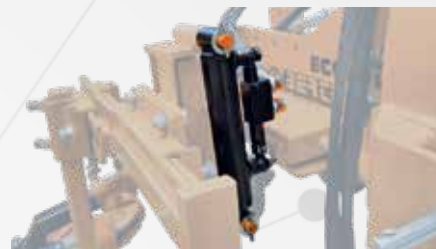
Levée hydraulique avec tuyaux et prises rapides
