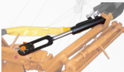
Vérin hydraulique pour la rétraction manuelle de disque
