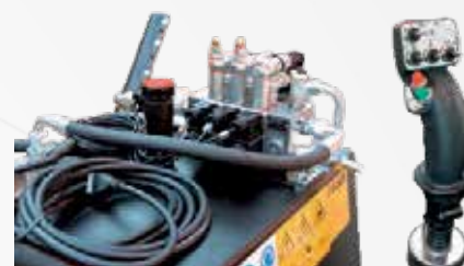
Comando elettrico joystick con elettrovalvole
