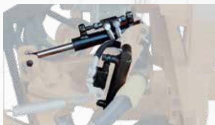
Martinetto idraulico per regolazione dell'altezza e dell'inclinazione
