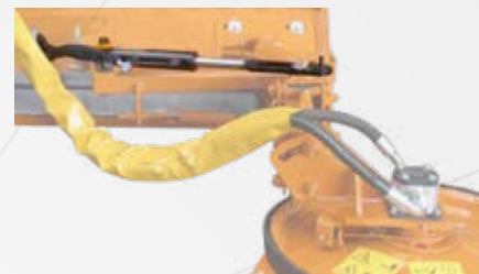
Martinetto idraulico per il rientro manuale del disco
