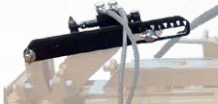
Inclinazione idraulica del corpo con tubi e innesti rapidi
