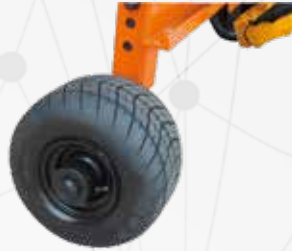
Gummiräder statt der Eisenräder
