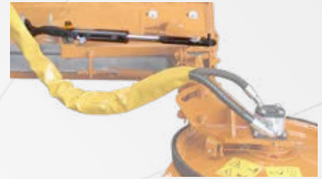
Einzugszylinder für Scheibe mit Schlauchen und Schnellkupplungen
