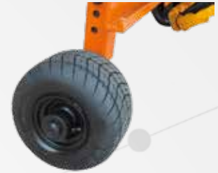
Gummiräder statt der Eisenräder
