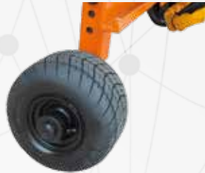
Gummiräder statt der Eisenräder
