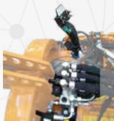
Hydraulikanlage Direktanschluss mit Platte, Schnellkupplungen, Ölkühler und elektrische Bedienung
