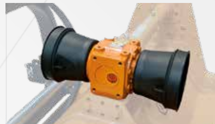
Boîtier avec roue libre et arbre de sortie 540/1000 t/min
