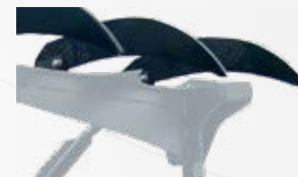
Râteaux "ripper" sur le rabatteur de branches
