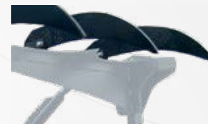
Râteaux "ripper" sur le rabatteur de branches
