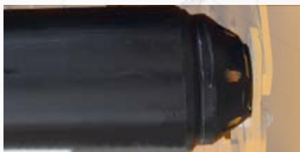
Rullo posteriore con campane imbullonate da 159 mm
