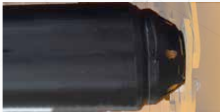
Stützwalze Ø 159 mit geschraubten Lagerungen
