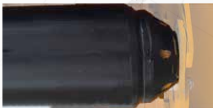
Stützwalze Ø 159 mit geschraubten Lagerungen
