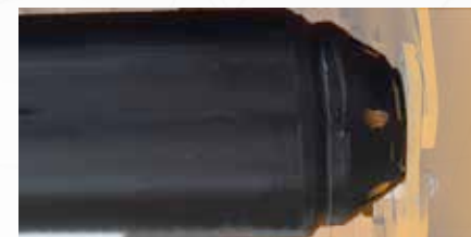
Rullo posteriore con campane imbullonate da 159 mm
