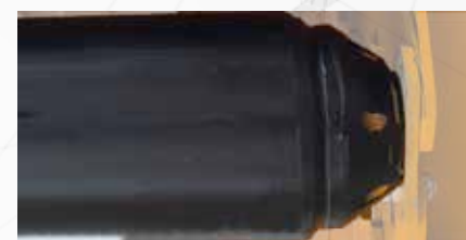
Rullo posteriore con campane imbullonate da 159 mm
