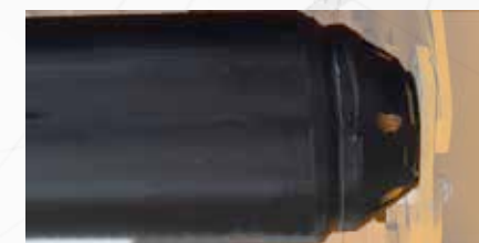
Rullo posteriore con campane imbullonate da 159 mm
