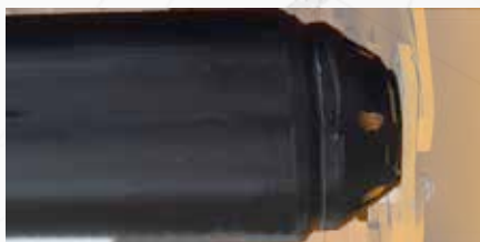
Rouleau palpeur de Ø 159 avec coupelles boulonnées
