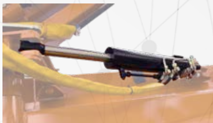
X-Float vérin avec piston flottant
