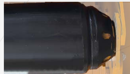
Rullo posteriore autopulente a campane imbullonate da 194 mm
