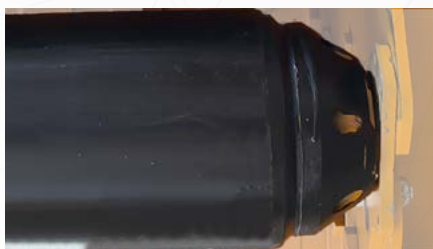
Rullo posteriore autopulente a campane imbullonate da 159 mm o 194 mm
