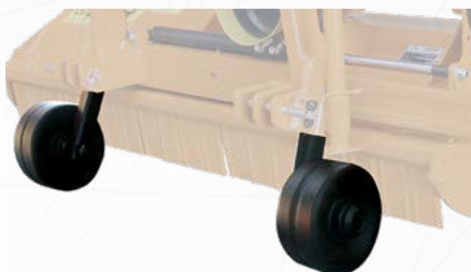
Ruote anteriori in ferro regolabili in altezza
