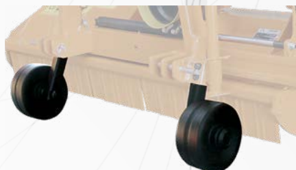
Ruote anteriori in ferro regolabili in altezza
