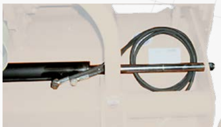
Spostamento idraulico con tubi e innesti rapidi
