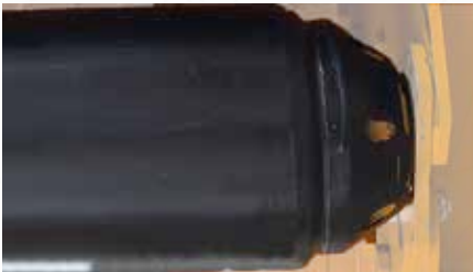
Selbstreinigende Stützwalze Ø 194 mm, mit geschraubten Lagerungen
