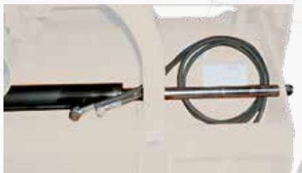
Déport hydraulique avec tuyaux et prises rap
