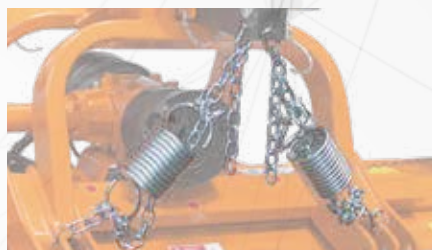
Système de soutien par ressorts du troisième point
