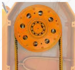
Arranque centrífugo Berti recomendado para rotor forestal
