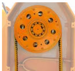
Arranque centrífugo Berti recomendado para rotor forestal
