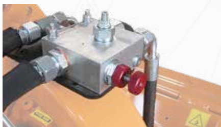
Kit de transmisión hidráulica del rotor "pick-up" con válvula de control de velocidad
