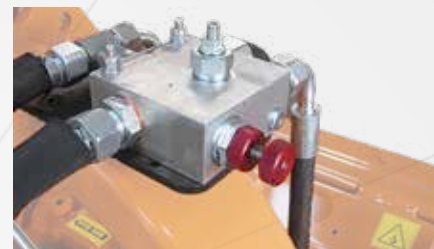
Barra de transmisión hidráulica del rotor "pick-up" para viajar por carretera
