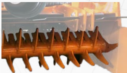
Rotore Pick-Up con denti a quantità maggiorata
